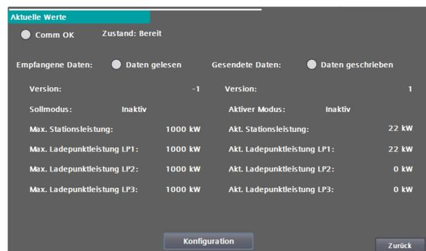
Abb 36: Datenstruktur des externen Leistungsmanagements für die Aktualwerte
