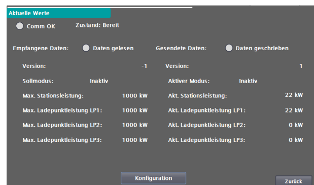
Abb 36: Datenstruktur des externen Leistungsmanagements für die Aktualwerte
